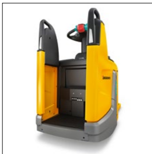
Компактная амортизированная площадка оператора с возможностью регулировки
